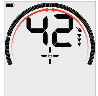
Stärkstes Zielsignal: Alle Diskriminierungssegmente sind eingeschaltet. Das Ziel befindet sich direkt unter der Mittellinie der Spule.
